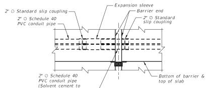
CONDUIT EXPANSION JOINT DETAIL
